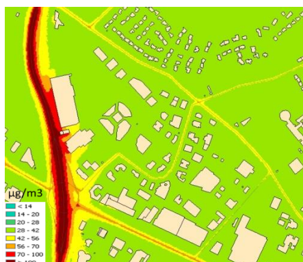
Figure 5 : Concentration moyenne en NO2 sur la période "critique" sans aménagement
