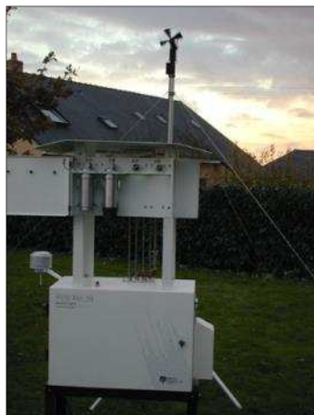
Vue du préleveur de chlorures particuliers et gazeux
