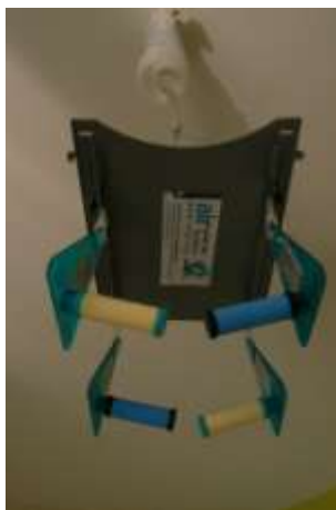
Photo 3 et 4 : dispositif de mesure des aldéhydes et BTEX suspendu au plafond des deux salles instrumentées
