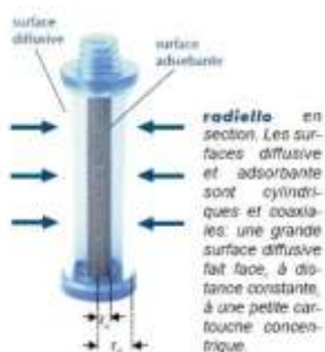
Photo 3 : symétrie du tube radiello (extrait du protocole de surveillance du formaldéhyde-LCSQA)
