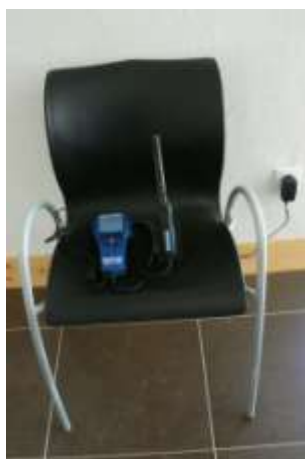
Photo 1 et 2 : appareil Q-Track mesurant le dioxyde de carbone, la température et l'humidité
