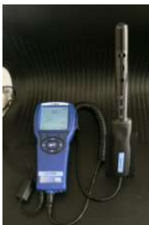
Photo 1 et 2 : appareil Q-Track mesurant le dioxyde de carbone, la température et l'humidité
