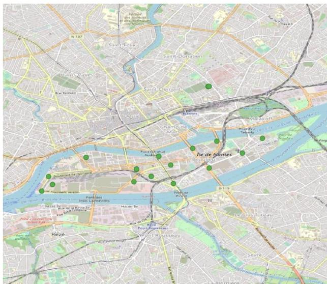
Une quinzaine de systèmes capteurs Atmotrack ont été installés sur différents sites de l'île de Nantes et sur la station de mesure de référence d'Air Pays de la Loire dans le cimetière de la Bouteillerie.
