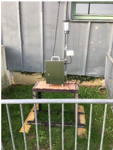
Vue du préleveur d'acide chlorhydrique gazeux
