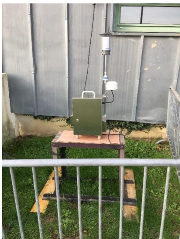
Vue d'un système de prélèvement par filtre
