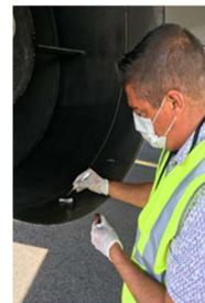
Les « signatures chimiques » des dépôts collectées respectivement sur la pièce mobile du train d'atterrissage (graisse) et sur l'intra-do de l'aile gauche sont similaires : présence de composés lourds à partir du temps de rétention de 30 minutes. Cette similitude suggère que les taches présentes sous l'aile sont liées à la graisse présente sur le train d'atterrissage notamment lorsqu'il est sorti.
