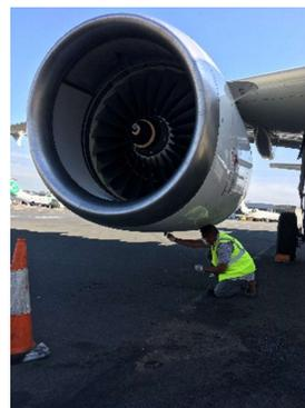
*Prélèvement (réf. L2103-20) au niveau du mât de drainage du réacteur droit*
