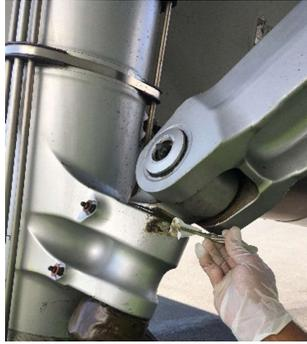
Prélèvement de graisse (réf. L2103-02)
