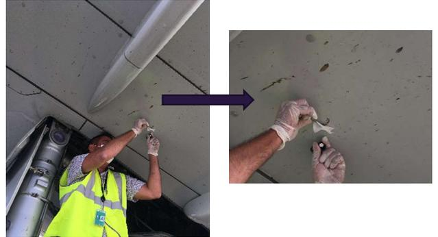
Prélèvement (réf. L2103-05) au niveau de l'intrados de l'aile gauche
