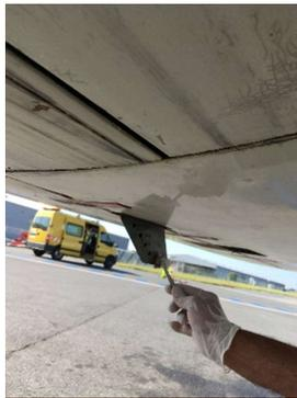
*Prélèvement (réf. L2103-10) au niveau du mât de drainage du réacteur gauche*
