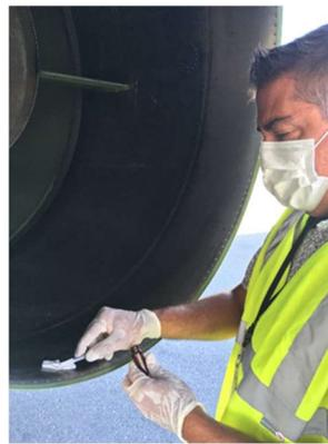
*Collecte de dépôts en sortie de réacteur*
