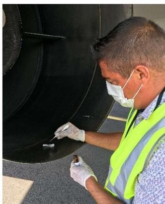
Prélèvement (réf. L2103-06) sur tuyère du réacteur gauche
