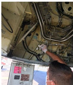
Prélèvement (réf. L2103-09) à l'intérieur du puits du train d'atterrissage gauche
