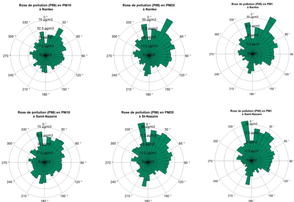
Figure A1 - roses de concentrations des PM10 (à gauche), PM2.5 (au centre) et PM1 (à droite) enregistrées sur les sites de référence à Nantes Bouteillerie (haut) et Saint-Nazaire (bas)
