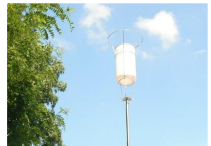
Figure 5 : jauge de récupération des eaux de pluie - dite "Jauge Owen"
