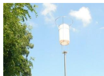
Figure 3. Préleveur d'eau de pluie (jauge Owen)
