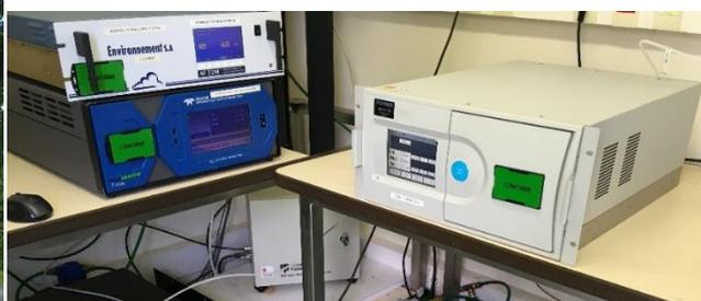
Figure 22 : laboratoire mobile (photo de gauche) et analyseurs automatiques de sulfure d'hydrogène (en haut à gauche) et de méthane (à droite) (photo de droite)
