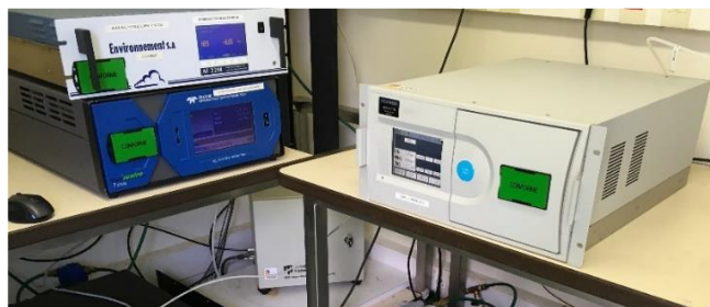
Figure 33 : laboratoire mobile (photo de gauche) et analyseurs de sulfure d'hydrogène (en haut à gauche) et de méthane (à droite) (photo de droite)
