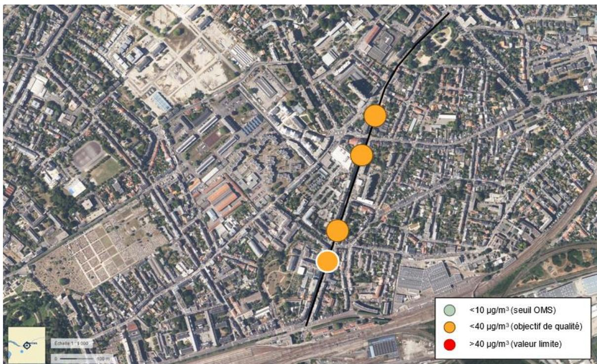
Figure 5 : cartographie des concentrations moyennes en NO<sub>2</sub> le long du Boulevard Dalby sur les 8 semaines de mesure
