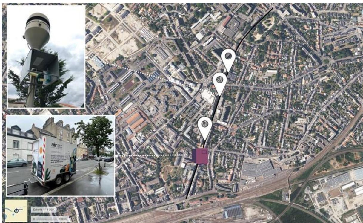
Figure 1 : localisation des sites de mesures automatiques (remorque-laboratoire) et de mesures passives (balises blanches) le long du Boulevard Dalby, à Nantes
