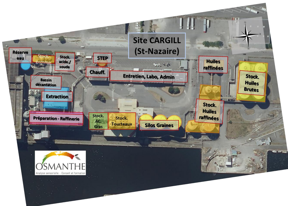
Plan de situation des principales unités de stockage et de production du site Cargill (Saint-Nazaire)
