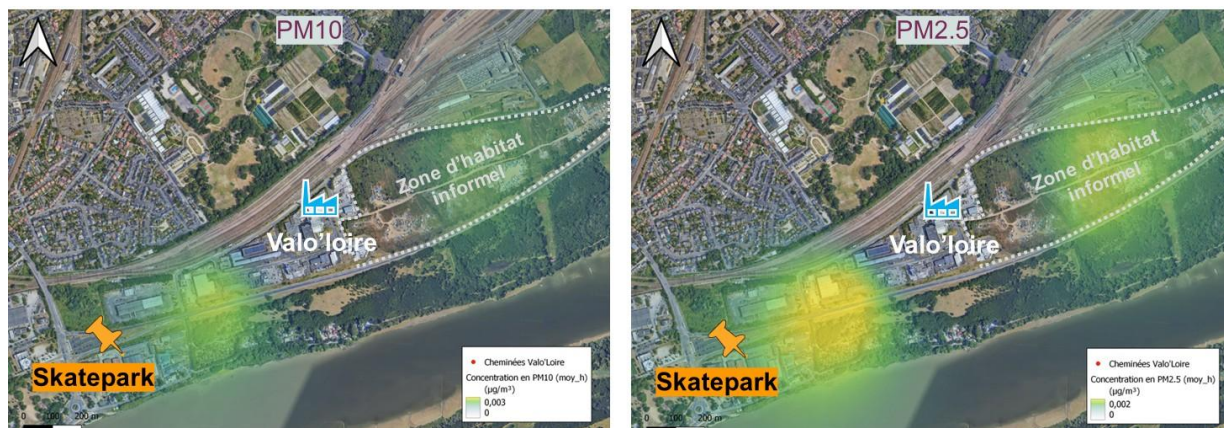
Figure 2 : modélisation des concentrations moyennes annuelles de PM10 (à gauche) et PM2.5 (à droite) issues des émissions spécifiques du CTVD
