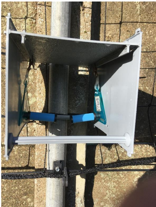
Figure 6 : boîte d'exposition des tubes, placée dans un corps diffusif bleu Radiello à l'aide d'un support triangulaire (à gauche). Tubes Radiello code 166 à usage unique (à droite)
