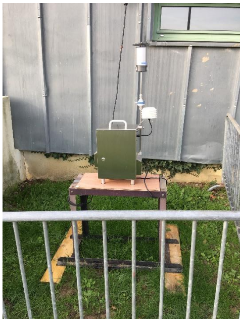
Vue du préleveur d'acide chlorhydrique gazeux
