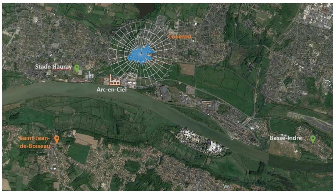
Figure 18 : rose de pollution des concentrations de pointe (P98) en SO 2 sur le site de la Gendarmerie à Couëron
