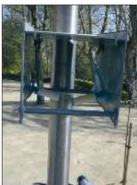
Figure 2 : Tubes à diffusion passive installés dans leur boîte de protection
